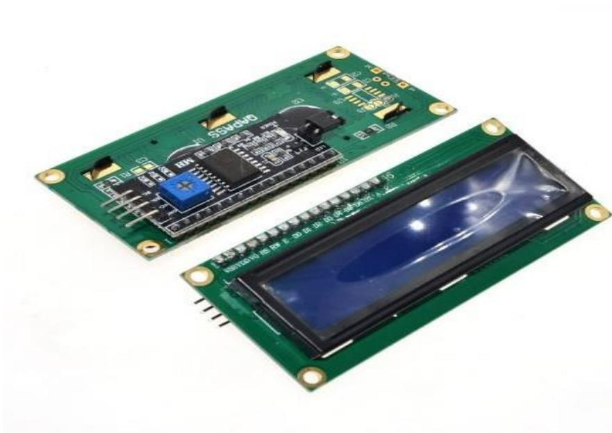
**Figure II.6** : Afficheur LCD
